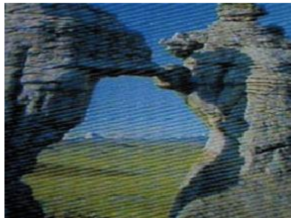
Interferencia causada por un transmisor de radio (Canales de Cable 17 al 22)
